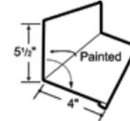
LG 108 SIDEWALL FLASHING
