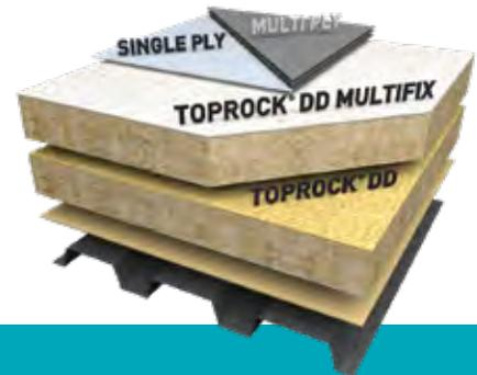
Las tablas de lana de roca ofrecen una mayor resistencia al fuego y estabilidad dimensional para el sistema de techo, lo que aumenta su resiliencia y duración. La masa de las tablas, además, modera la temperatura del techo y no disminuye la resistencia térmica con el tiempo.
