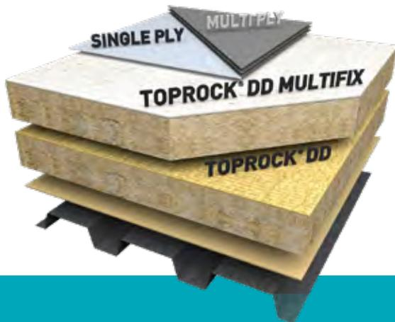
Los productos TOPROCK® DD y MONOBOARD® están disponibles en dos opciones diferentes de revestimiento: bitumen o fibra de vidrio con recubrimiento mineral. Los productos TOPROCK® DD Plus y MONOBOARD® Plus recubiertos con bitumen se utilizan en aplicaciones de adherencia en caliente, tales como soplete o asfalto de trapeador caliente. El revestimiento de fibra de vidrio con recubrimiento mineral utilizado en TOPROCK® MULTIFIX se puede usar tanto con adhesivos calientes como fríos.
